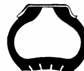
FALTA DE PRESSÃO
