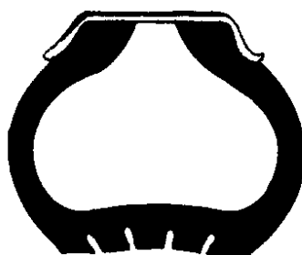
FALTA DE PRESSÃO
