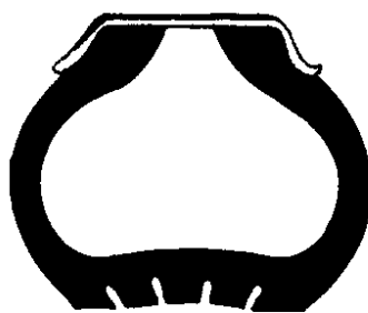
FALTA DE PRESSAO
