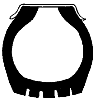
EXCESSO DE PRESSAO
