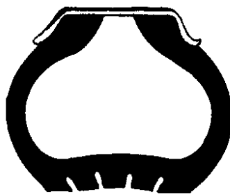
FALTA DE PRESSAO
