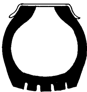
EXCESSO DE PRESSAO
